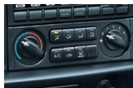
オゾンセーフエアコン+プッシュ式 ヒーターコントロールパネル
