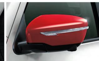
NISMO専用サイドターンランプ付電動格納式リモコンカラードアミラー(ドアロック連動自動格納機能付)
